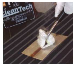
Reinigen der Schweißnaht
