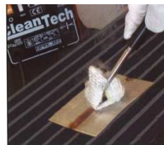
Reinigen der Schweißnaht
