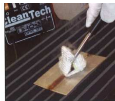
Reinigen der Schweißnaht
