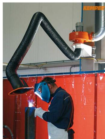
**Abluftset mit Ventilator 1.000m<sup>3</sup>/h + Schlaucharm 3m**
