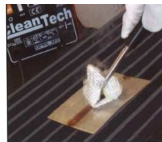
Reinigen der Schweißnaht
