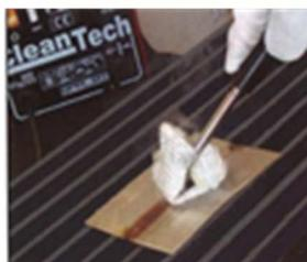
Reinigen der Schweißnaht
